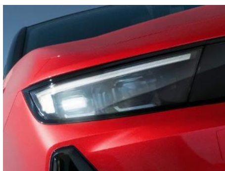
Intelli-Lux LED® pixelové svetlo Adaptívne svetlá s 84 LED prvkami v každom svetle sa prispôbujú dopravným podmienkam automatickým vypínaním jednotlivých jednotiek
